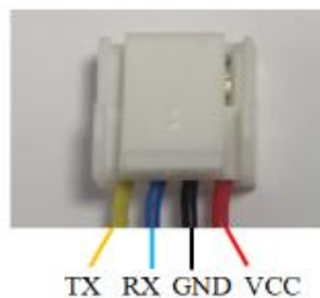
图 3: TOFSense S 实际接口线序
