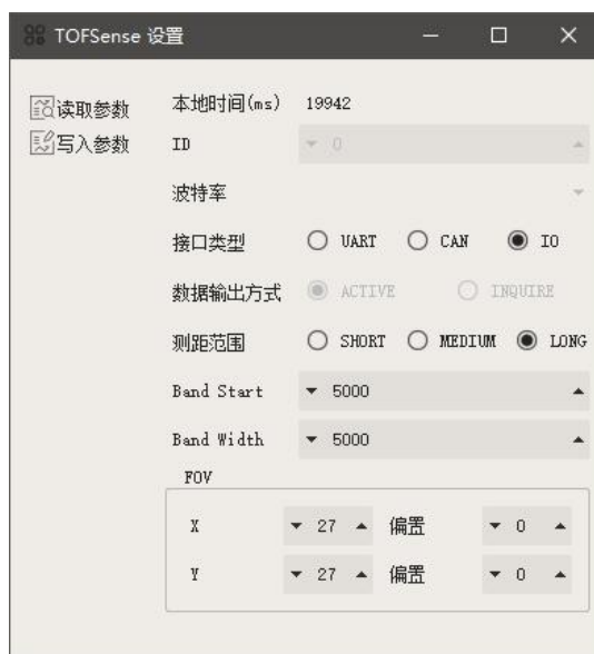
图 5: I/O 输出模式配置图
