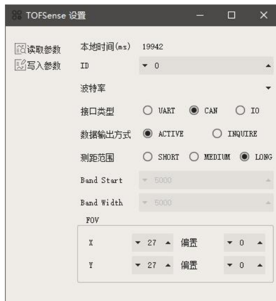
图 3: CAN 主动输出模式配置图
