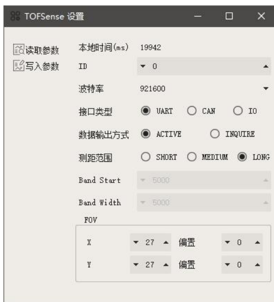
图 1: UART 主动输出模式配置图
