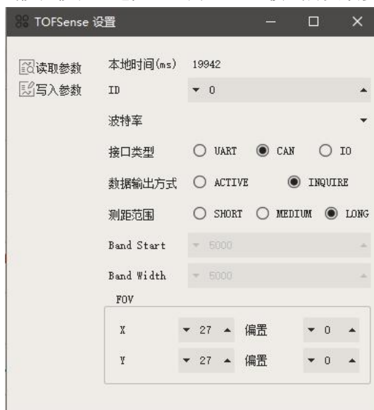
图 4: CAN 查询输出模式配置图
