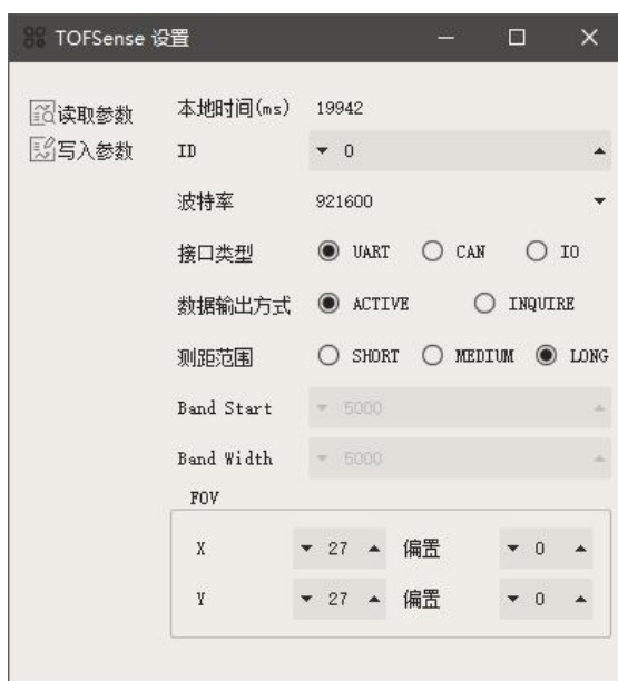
图 1: UART 主动输出模式配置图
