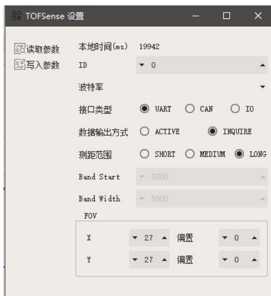
图 2: UART 查询输出模式配置图
