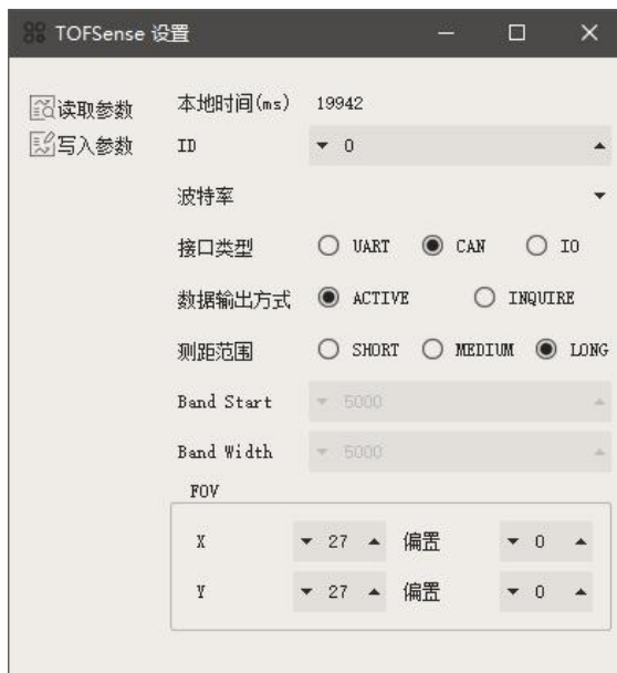
图 3: CAN 主动输出模式配置图
