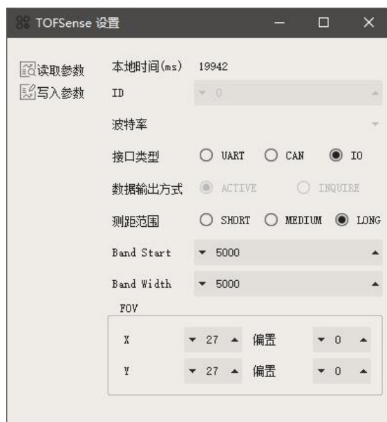
图 5: I/O 输出模式配置图
