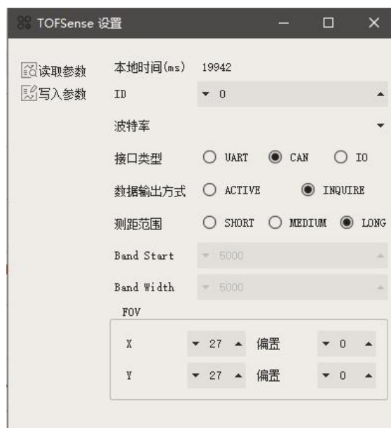
图 4: CAN 查询输出模式配置图
