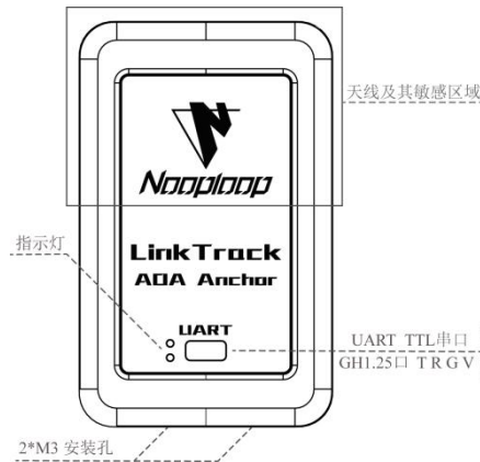
图 1: LinkTrack AOA Anchor 构造示意图
